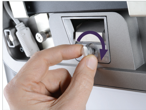
13. Gire el escáner y ajuste el tornillo mariposa para asegurar la pantalla HD
