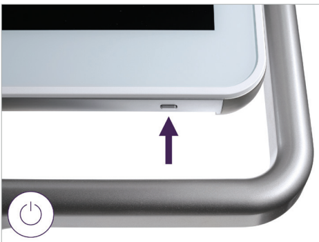
24. Presione el botón para encender el escáner
