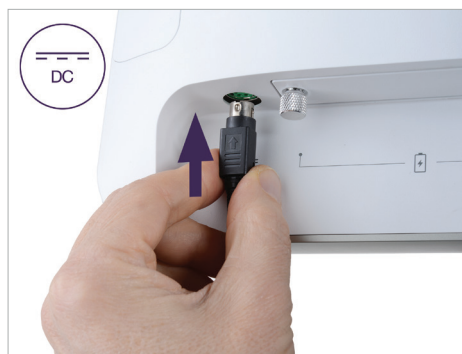
8. Conecte el cable de alimentación al puerto etiquetado como CC
