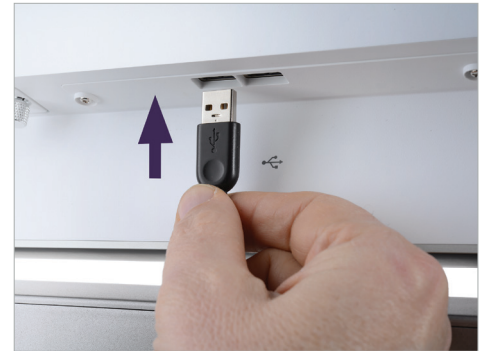
23. Conecte la cámara web al puerto USB en la parte inferior de la pantalla HD
