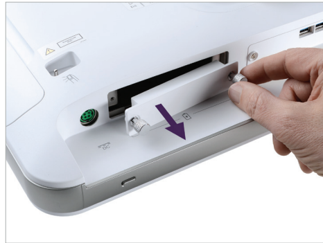
10. Retire la tapa de la batería
