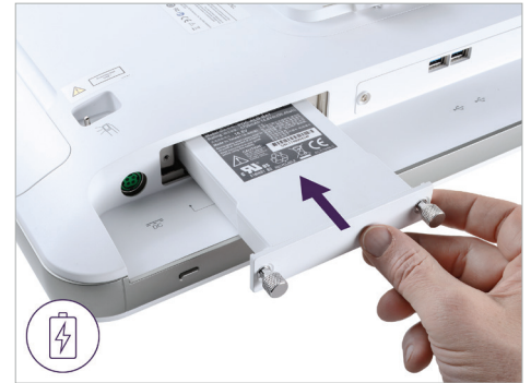
11. Deslice la batería en la ranura de la batería y ajuste los tornillos mariposa
